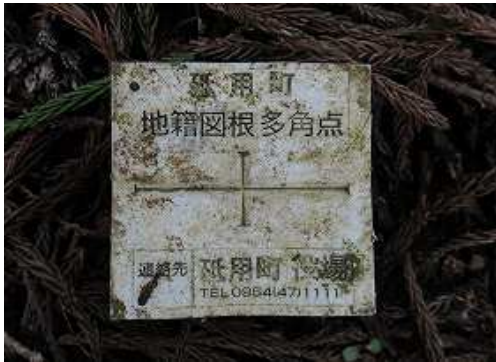
尾根斜面に砥用町の地籍図根多角点の杭を見る。
