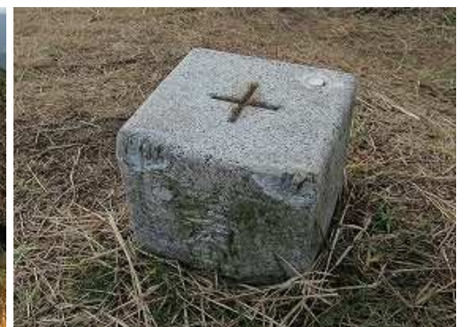
明治21年選点の一等三角点:防住山(ぼうじゅさん)(404.34m)が設置されている。
