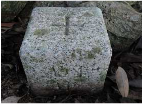
昭和46年選定の四等三角点:くろまき山(347.55m)が設置されている。
