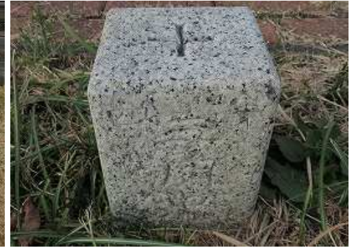
昭和46年に選点された四等三角点:熊ノ岳が設置されている。
