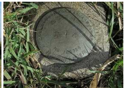
平成7年選点の四等三角点：みそこぶし山(1299.57m)の金属鉢が設置されている。
