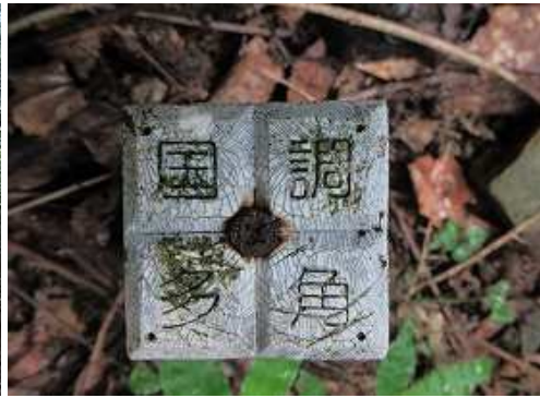
国調多角杭を見る。
