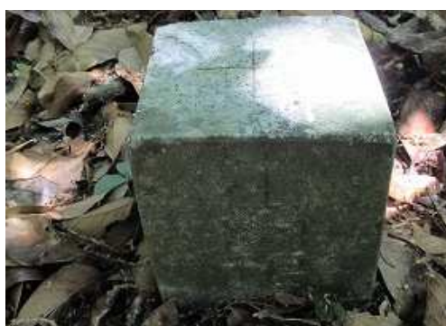
図根点の杭が設置されている。
