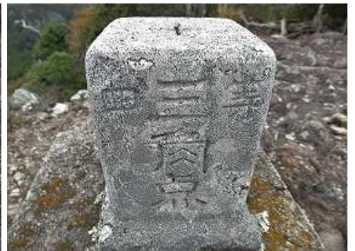
昭和41年選点の四等三角点:堂明(353.01m)が設置されている。
