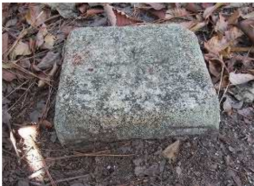
明治27年選点の二等三角点:大特牛岳(690.28m)が設置されている。
