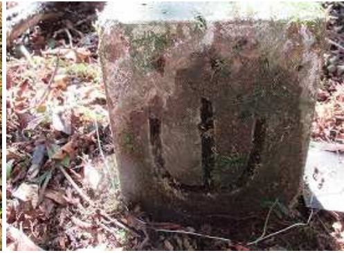
杭の苔を落としたら「補点」「山」の文字が現れ補点杭と判明した。
