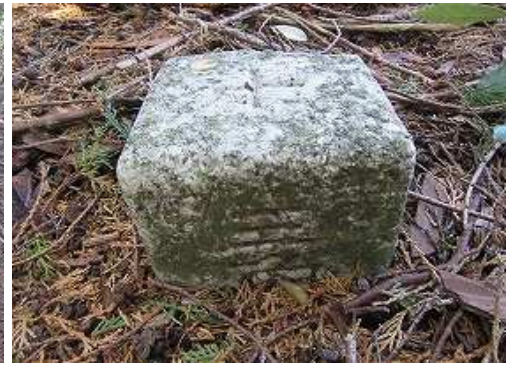
昭和26年選定の四等三角点: 稚兒忘(363.61m)で此処が稚兒忘南峰(364m)とされている。
