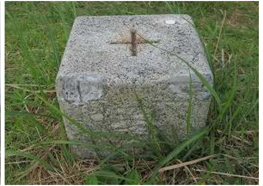
基山(404m)には一等三角点・防住山が設置されている。
