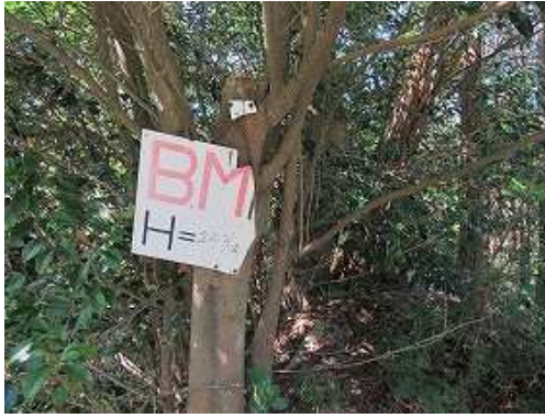
出合傍にBM標を見る。
