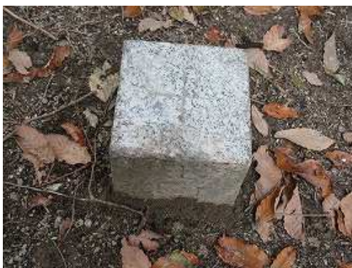
尾根筋に 補点杭 を見る。
