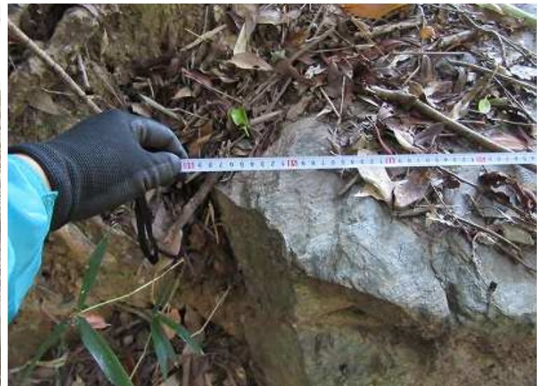
奥行:60cm 緑泥片岩の比重は \gamma = 2.8t/m^3 なので W = 1.3t となる
