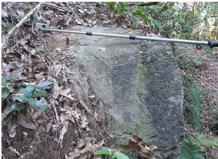
奥行:74cm 緑泥片岩の比重は \gamma = 2.8t/m^3 なので W = 1.7t となる
