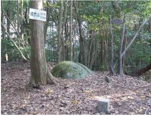
三等三角点成竹が設置されているが、樹木に遮られ展望は得られない。
